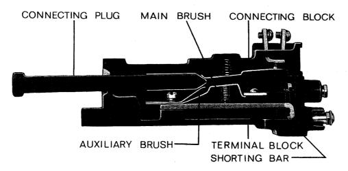
NOTE: AFTER ENGAGING AUXILIARY BRUSH CONNECTING PLUG TRAVELS  $\frac{1}{4}$  INCH BEFORE ENGAGING THE MAIN BRUSH ON THE TERMINAL BLOCK
