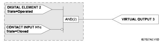
Figure 5-4: LOGIC FOR VIRTUAL OUTPUT 3
