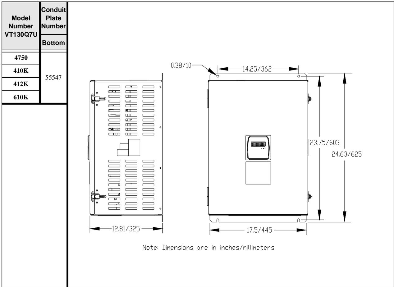
**Figure 16. Conduit Plate 55547.**
