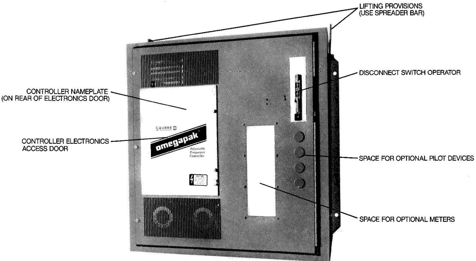
4.2 OMEGAPAK 3500 CONTROLLER — WITH ELECTRONICS DOOR OPEN
